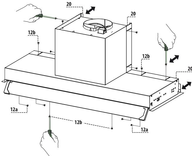
**ATENÇÃO!** O corpo do exaustor tem de ser montado primeiro no armário de cozinha e só depois fixado na parede.
